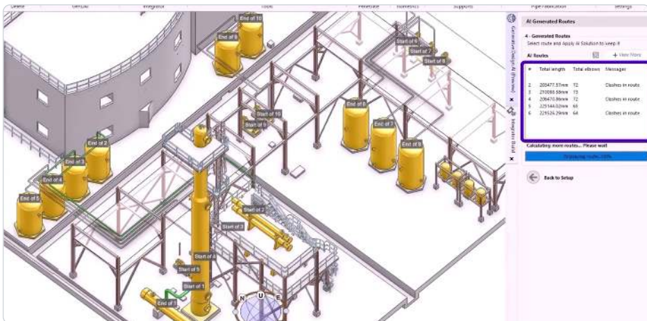
AVEVA: varijante trase s duljinom, brojem koljena i kolizijama
